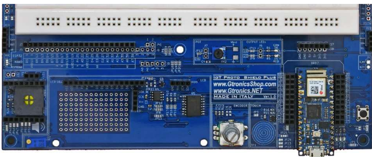
Figure 10 – una scheda ARDUINO NANO (NANO33 IoT) inserita nella IOT PROTO SHIELD PLUS
