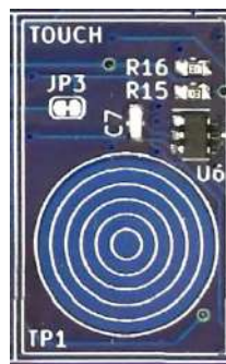
Figure 24 – Sezione TOUCH della IoT PROTO SHIELD PLUS
