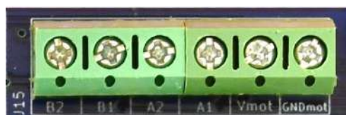
Figure 89 – Connettore a vite J15 della IOT PROTO SHIELD PLUS
