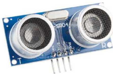
Figure 81 – Modulo HC-SR04 di larga diffusione sul mercato
