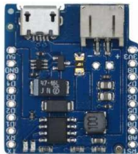
Figure 111 – Tipico modulo battery shield di largo utilizzo
