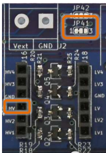
Figure 103 – JP41 e pin#3 dell'header J16 della sezione Level Shifter della IoT PROTO SHIELD PLUS
