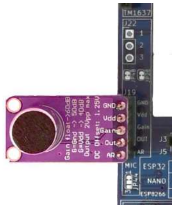
Figure 74 – Modulo microfonico MAX9814 inserito nell'header J19
