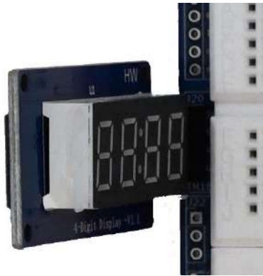
Figure 40 – Modulo TM1637 inserito nell'header J20 sulla IoT PROTO SHIELD PLUS
