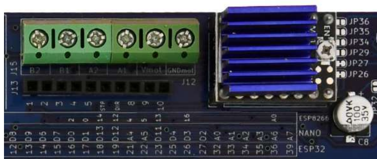
Figure 94 – Un modulo TMC2xxx inserito nel socket BRD2
