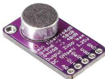
Figure 73 – Modulo microfonico MAX9814 di larga diffusione
