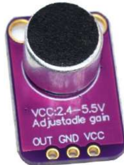
Figure 75 – Modulo microfonico MAX4466 di larga diffusione
