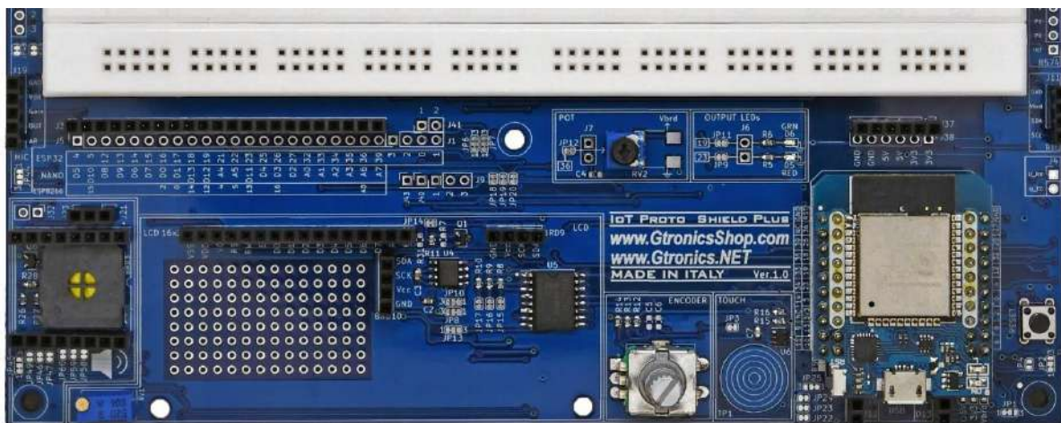
Figure 12 – La scheda ESP32 mini D1 inserita nella IOT PROTO SHIELD PLUS
