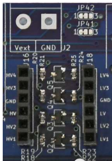
Figure 101 – LA sezione Level Shifter della IoT PROTO SHIELD PLUS
