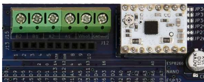
Figure 96 – Un modulo DRV8834 inserito nel socket BRD2
