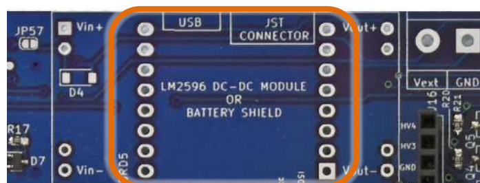
Figure 112 – Il socket BRD5 per collegare il modulo battery shield sulla IOT PROTO SHIELD PLUS
