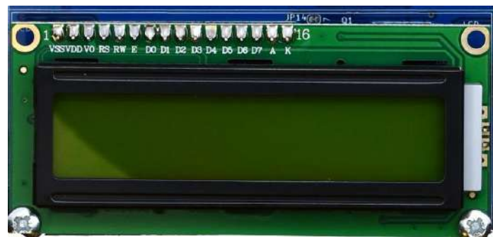
Figure 35 – Un display LCD 1602 inserito nell’header 16 pin della IoT PROTO SHIELD PLUS
